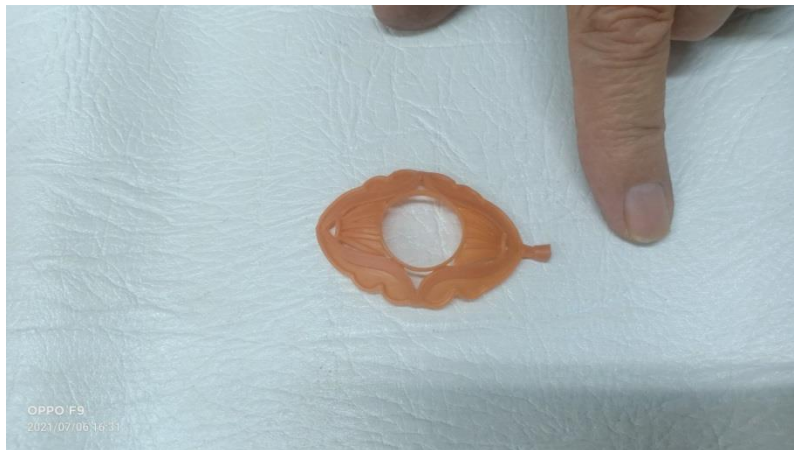
Maquette en cire pour moulage d'une pièce de Mehazma (Atelier Benhassine)
